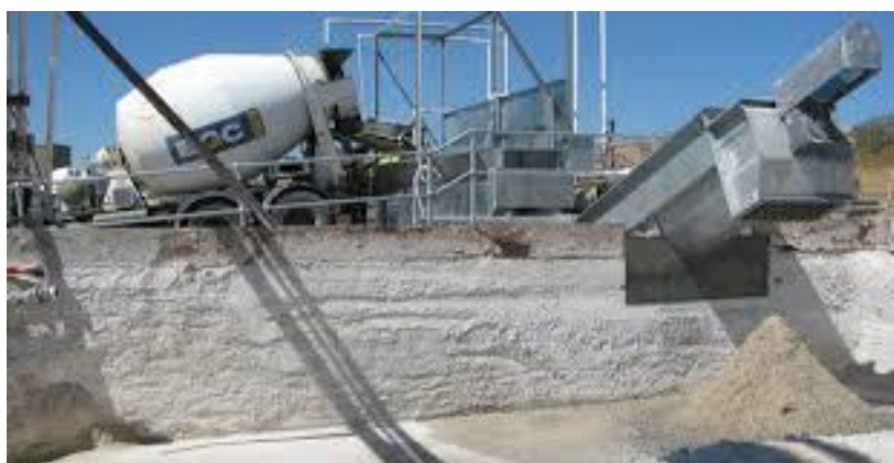
ภาพ 4 กากคอนกรีตจากรถโม้เข้าเครื่องแยก หิน ทราย น้ำสลัดจ์ ที่มา: WAM Thailand (2562) เรื่อง เครื่องแยกหินทราย
