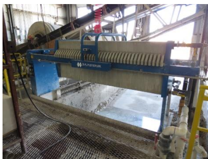
ภาพ 5 เครื่องอัดตะกอน(filter plate) จะแยกของเหลวออกจากอนุภาคละเอียดของซีเมนต์
